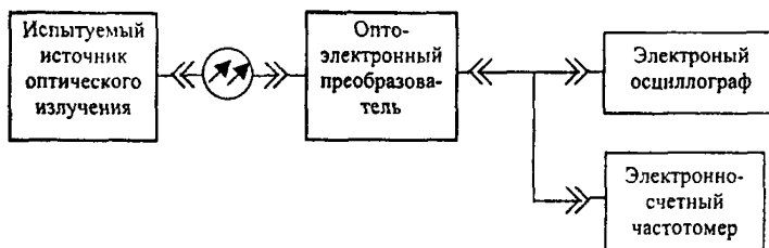
Рисунок 4 - Схема измерения амплитудно-временных параметров импульсно-модулированного сигнала
