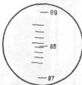
Рис. 10.12. Поле зрения окуляра вертикального круга-искателя
