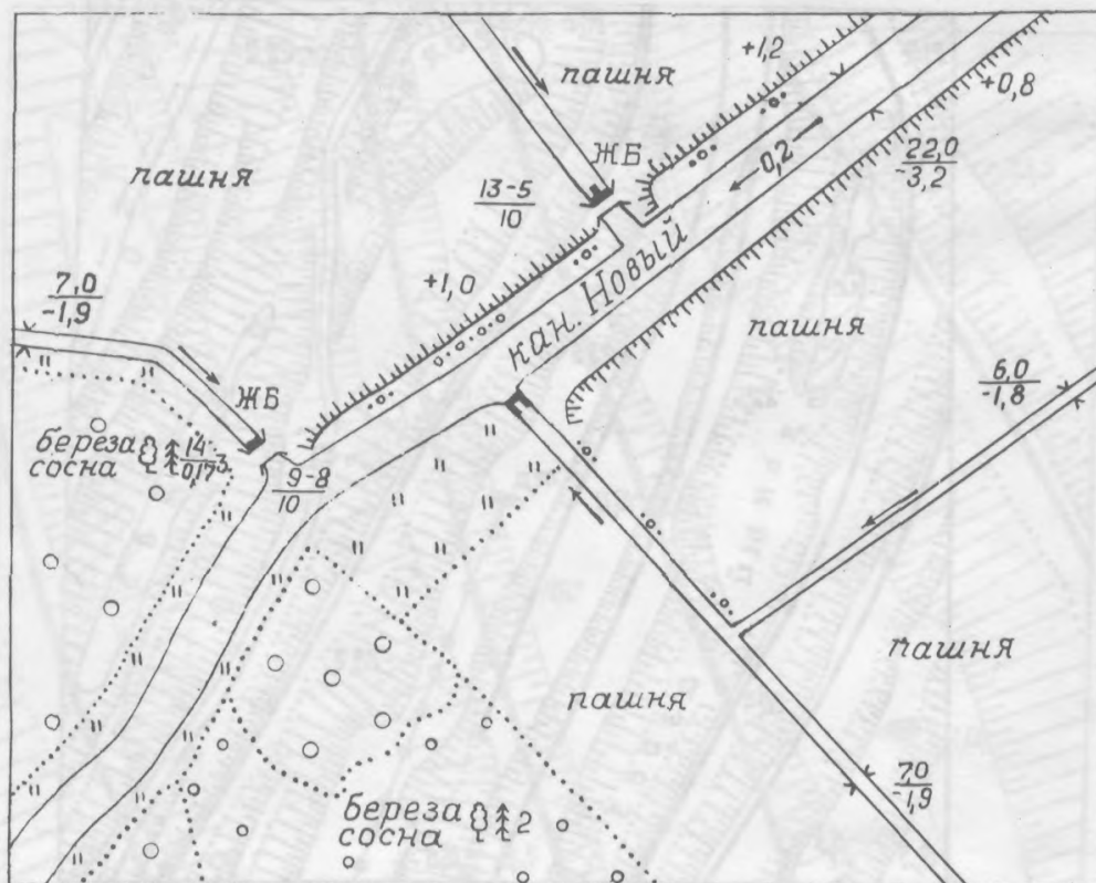
Рис. 28. Образец дешифрирования объектов осушительной мелиорации, масштаб 1:5000
