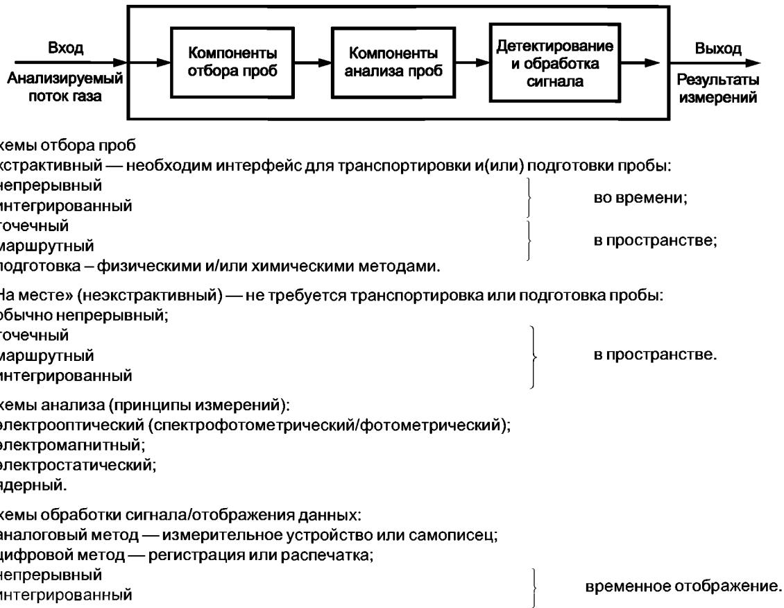
Рисунок D.1 — Варианты измерительной системы
