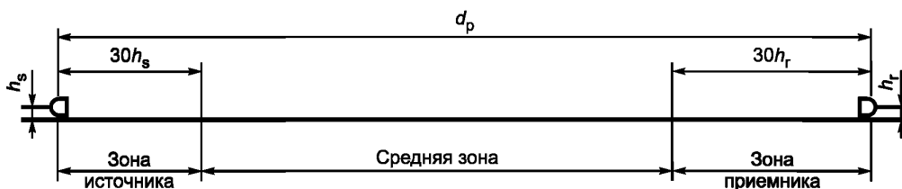
Рисунок 1 — Три основные зоны при определении затухания из-за влияния земли
