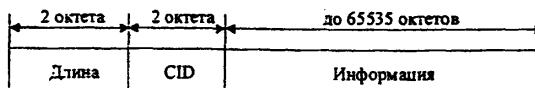
Рисунок 6.14 – Формат пакета для передачи информации по логическому каналу в ориентированном на соединение режиме.
