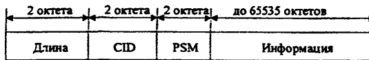
Рисунок 6.15 - Формат пакета для передачи информации по логическому каналу в неориентированном на соединение режиме
