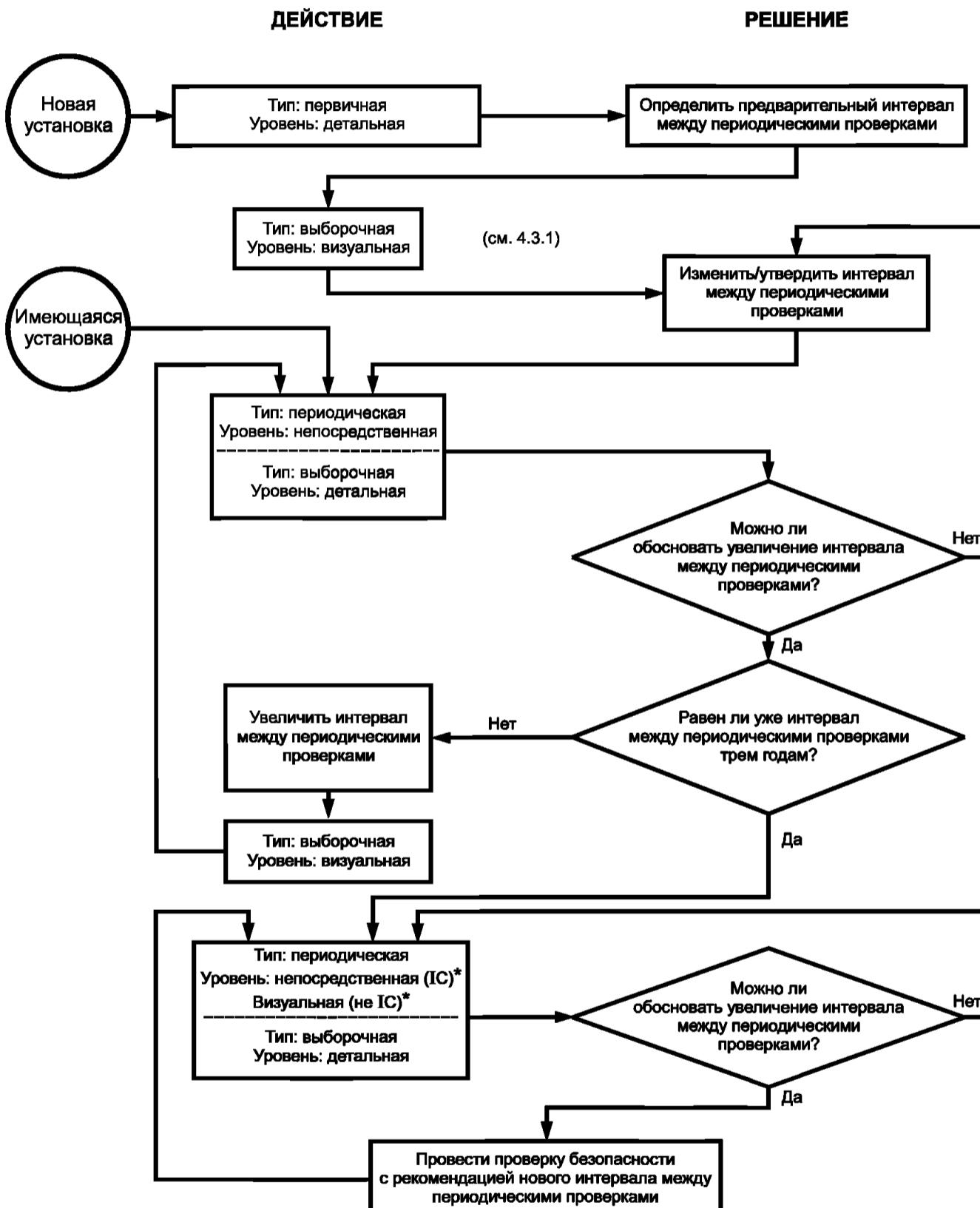
\* IC — способность к воспламенению в обычном режиме работы, т. е. когда в нормальном режиме работы встроенных компонентов электрооборудования возникают способные к воспламенению взрывоопасной среды дуговые разряды, искры или температура поверхности.
