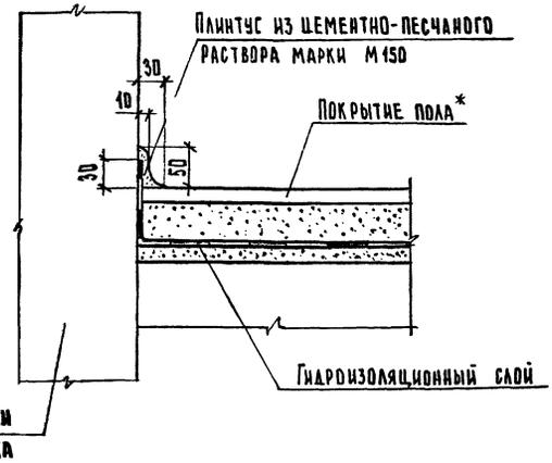
\* ПОКРЫТИЕ ПОЛА БЕТОННОЕ, МОЗАИЧНО-БЕТОННОЕ, ПОЛИМЕРЦЕМЕНТНО-БЕТОННОЕ, ПОЛИВИНИЛАЦЕТАТНО-БЕТОННОЕ, ПОЛИВИНИЛАЦЕТАТНО-ЦЕМЕНТНО-ПЕСЧАНОЕ, КСИЛОАНТОВОЕ И ИЗ ИСКУССТВЕННЫХ И ЕСТЕСТВЕННЫХ КАМНЕЙ.
