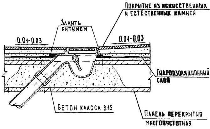
ОТВЕРСТИЕ ДЛЯ ТРАПА В ПЛИТЕ ПРОБИВАЕТСЯ ПО МЕСТУ.
