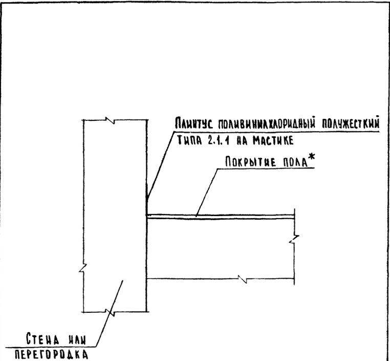
\* ПОКРЫТИЕ ПОЛА ИЗ ТОНКОСЛОЙНЫХ ПОЛИМЕРНЫХ МАТЕРИАЛОВ, КОВРОВЫХ ПОКРЫТИЙ, БЕСШОВНОЕ НА ОСНОВЕ ЦЕМЕНТА И ПОЛИМЕРОВ, ИЗ ИСКУССТВЕННЫХ И ЕСТЕСТВЕННЫХ КАМНЕЙ.
