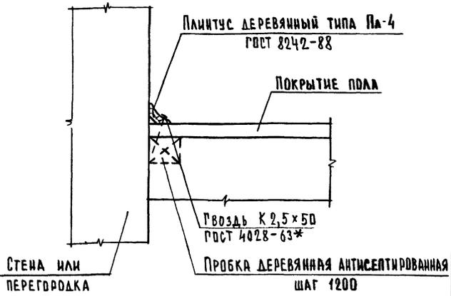
1. ПОКРЫТИЕ ПОЛА ИЗ ДРЕВЕСИНЫ, ТОНКОСЛОЙНЫХ ПОЛИМЕРНЫХ МАТЕРИАЛОВ И КОВРОВЫХ ПОКРЫТИЙ.
