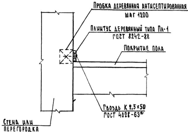
ПОКРЫТИЕ ПОЛА ИЗ ДРЕВЕСИНЫ, ТОНКОСЛОЙНЫХ ПОЛИМЕРНЫХ МАТЕРИАЛОВ И КОВРОВЫХ ПОКРЫТИЙ.
