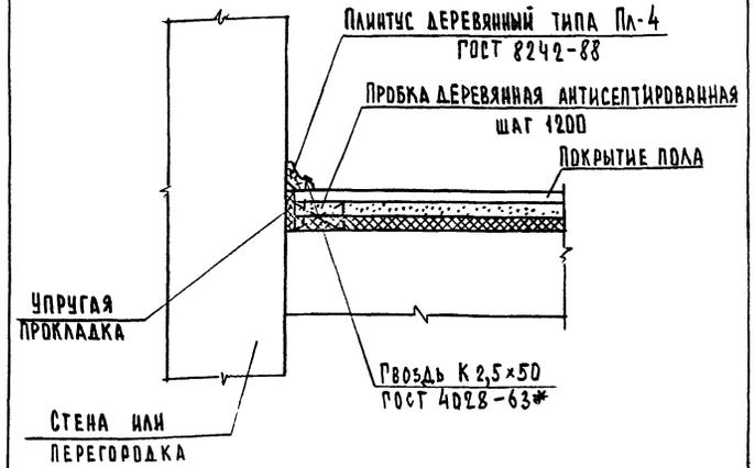
1. ПОКРЫТИЕ ПОЛА ИЗ ДРЕВЕСИНЫ, ТОНКОСЛОЙНЫХ ПОЛИМЕРНЫХ МАТЕРИАЛОВ И КОВРОВЫХ ПОКРЫТИЙ.
