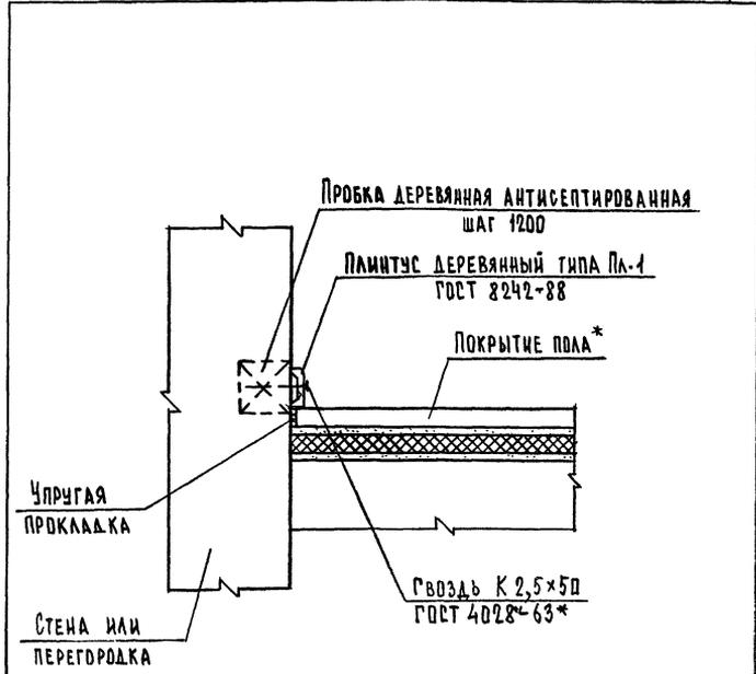
\* ПОКРЫТИЕ ПОЛА ИЗ ДРЕВЕСИНЫ, ТОНКОСЛОЙНЫХ ПОЛИМЕРНЫХ МАТЕРИАЛОВ И КОВРОВЫХ ПОКРЫТИЙ.
