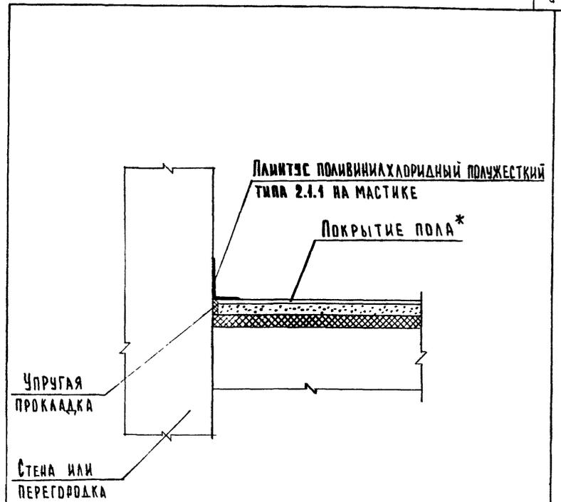
\* ПОКРЫТИЕ ПОЛА ИЗ ТОНКОСЛОЙНЫХ ПОЛИМЕРНЫХ МАТЕРИАЛОВ, КОВРОВЫХ ПОКРЫТИЙ, БЕСШОВНОЕ НА ОСНОВЕ ЦЕМЕНТА И ПОЛИМЕРОВ.
