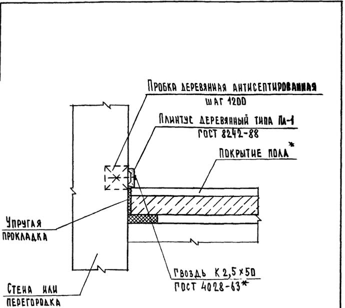
\* ПОКРЫТИЕ ПОЛА ИЗ ДРЕВЕСИНЫ, ТОНКОСТЕННЫХ ПОЛИМЕРНЫХ МАТЕРИАЛОВ И КОВРОВЫХ ПОКРЫТИЙ.
