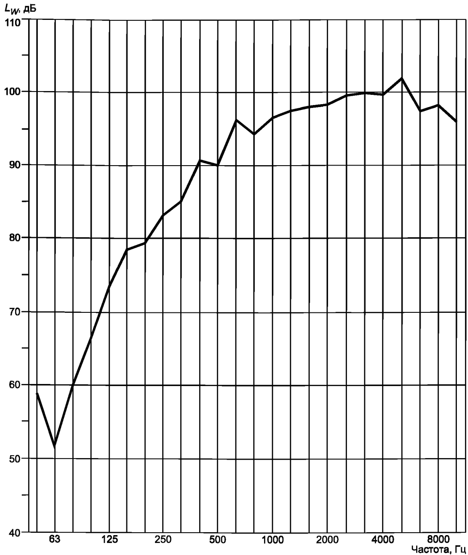
Рисунок В.1 — Спектр уровней звуковой мощности искусственного источника шума, соответствующего приложению А (Спектр определен измерениями по ГОСТ 31274.)
