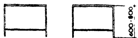
75 ПОДСТАВКА ДЛЯ НАСТОЛЬНО-СВЕРКАЛЬНОГО СТАНКА НС-12А СХЕМА.
