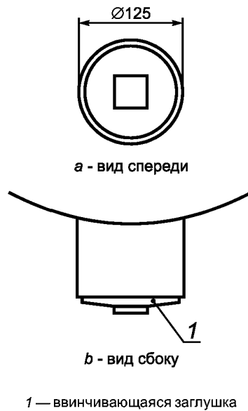
Рисунок F.2 — Пример круглого порта доступа
