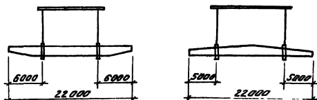
Схема строповки балок
