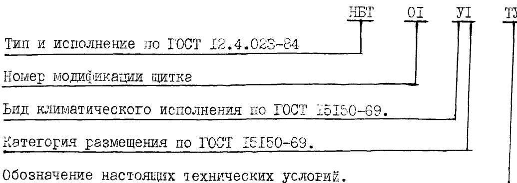
Пример записи обозначения щитка при его заказе и в документации: "Щиток НБТ-О1 У1. ТУ 002-00.ИСРМ 305607.С04"
