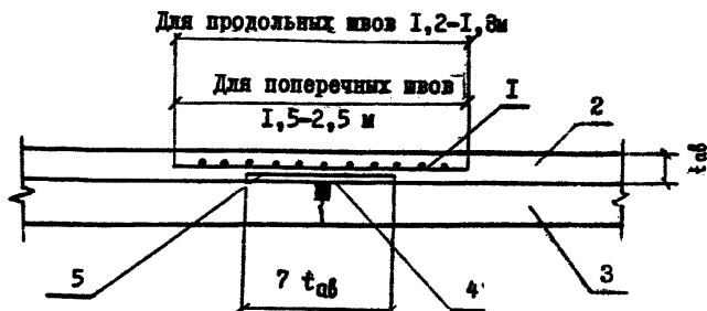
Рис. 2. Конструкция армирования однослойного асфальтобетона: 1 - стеклопластиковая сетка; 2 - слой усиления из асфальтобетона; 3 - существующее жесткое покрытие; 4 - побелка известковым молоком; 5 - перлит
