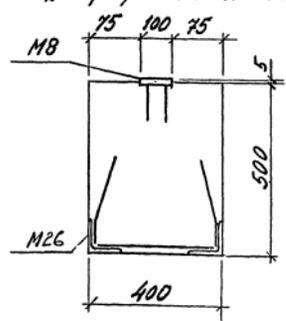
Конструкцию и размер металла на закладные изделия см. толькою серию 3.400.2-14.93, в.1.
