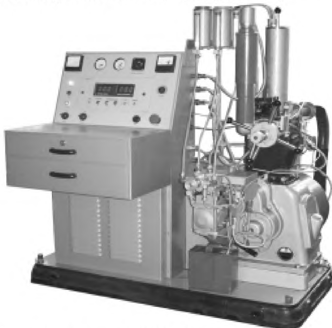
Рисунок 1 — Установка ИДТ-90 для определения цетанового числа
