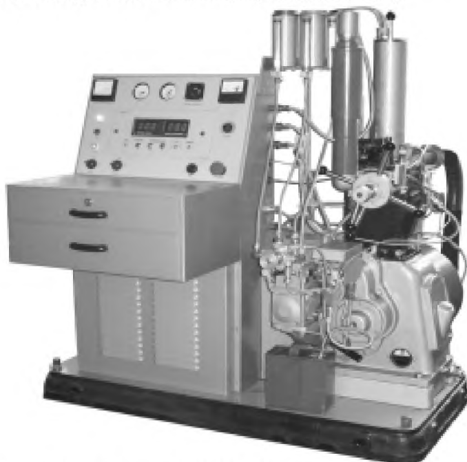
Рисунок 1 — Установка ИДТ-90 для определения цетанового числа
