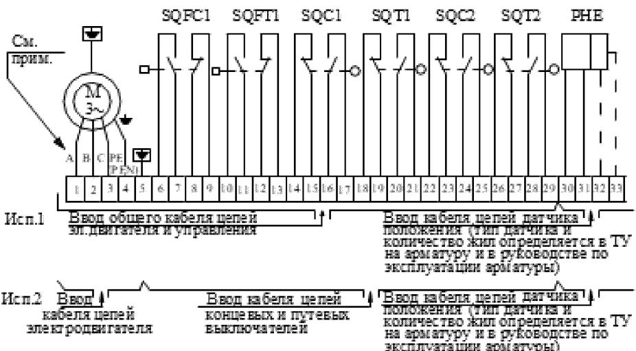
М-электродвигатель трехфазный асинхронный
