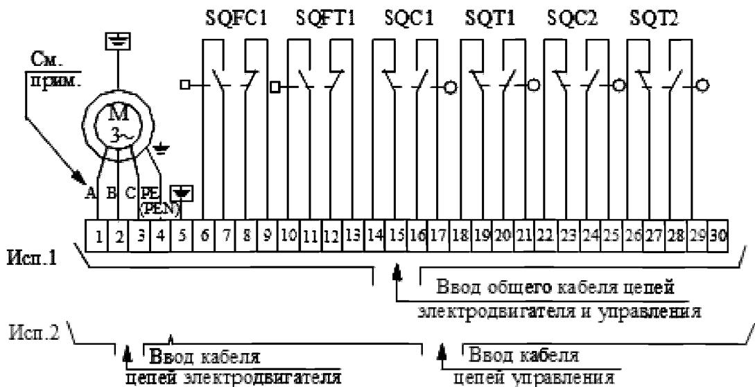
М-электродвигатель трехфазный асинхронный
