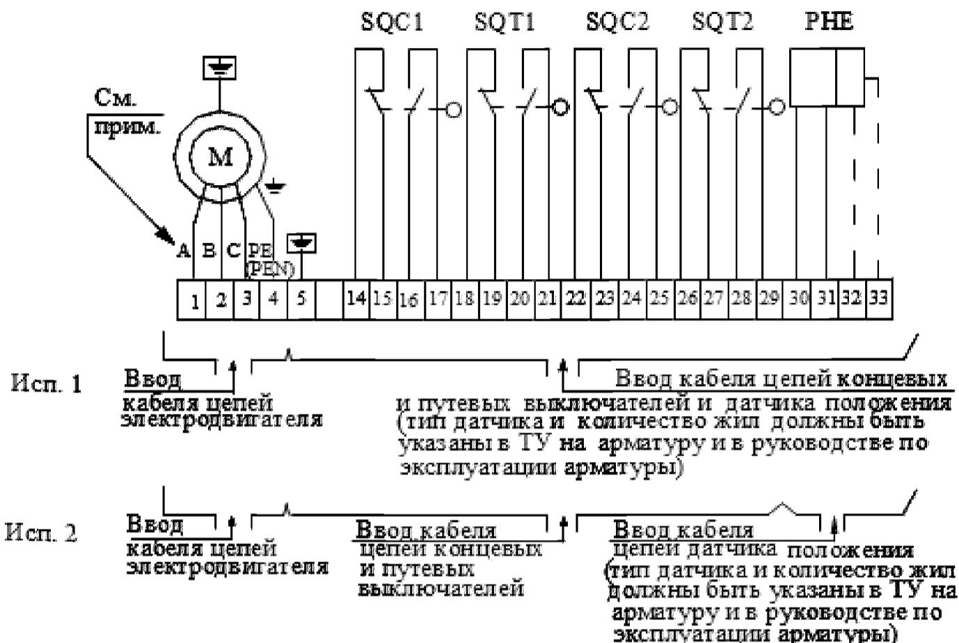
М-электродвигатель одно- или трехфазный асинхронный
