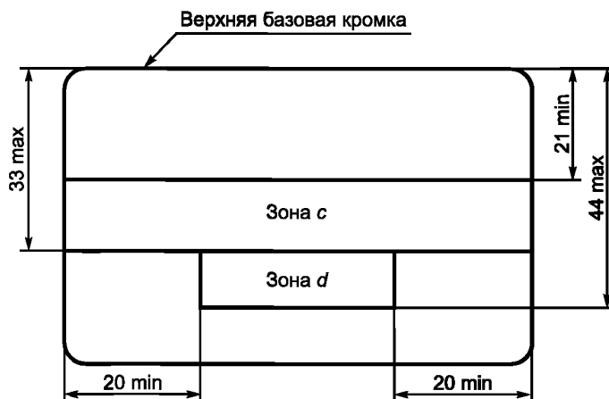
Рисунок 2 — Зоны с ненормируемой непрозрачностью на картах формата ID-1
