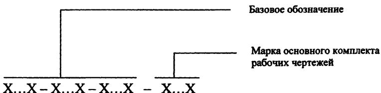
Пример обозначения основного комплекса рабочих чертежей здания:
