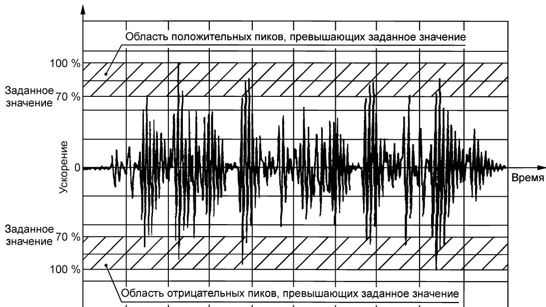
Рисунок 1 — Пример типичного отклика колебательной системы, возбуждаемой заданным времененным процессом (пороговое значение 70 %)
