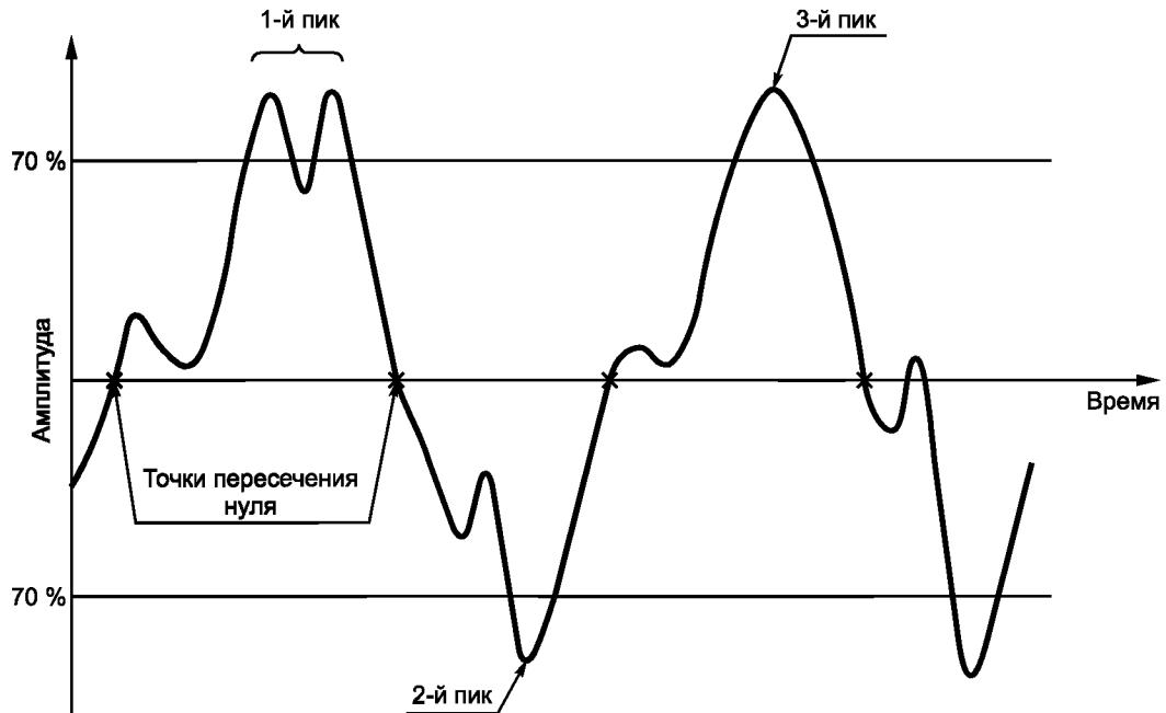
Рисунок 2 — Пример обнаружения пиков отклика, превышающих пороговое значение (70 %)
