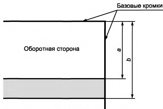
Рисунок 4 — Расположение дорожки для формата TFC.0
