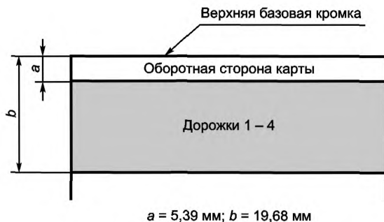
Рисунок 8 — Расположение и высота полосы при четырех дорожках
