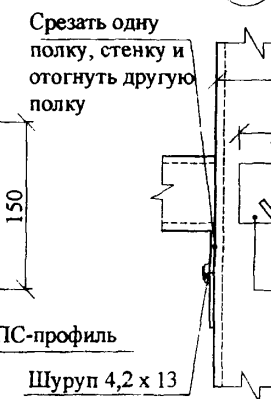
6 Срезать одну полку, стенку и отогнуть другую полку
