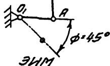
РИС.7. Сочленение ЭИМ с рычажным регулирующим клапаном (обратного типа, линейная характеристика сочленения):
