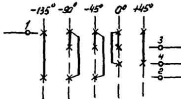
Вертикальные и горизонтальные линии, цифры, кружочки и (\*) в приведенном условном графическом обозначении переключателя имеют то же назначение, что и в примере п. I.3.
