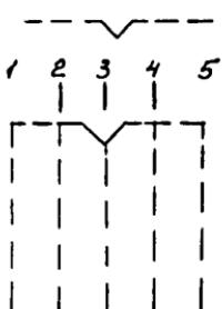
обозначение фиксирующего механизма по ГОСТ 2.721-74;
