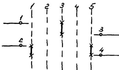
I.5. Многопозиционные переключатели, у которых позиция замыкания соответствующего контакта при одних и тех же положениях переключателя меняется в зависимости от перемещения рукоятки переключателя слева направо и справа налево, изображаются следующим образом (на примере условного графического обозначения переключателя ПМО с контактом 9<sub>3</sub>):
