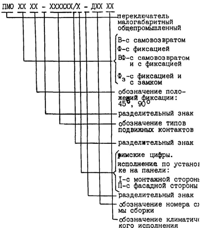
Пример условного обозначения переключателя ПМОФ с фиксацией рукоятки через 90°, предназначенного для установки с фасадной стороны панели при заказе: "Переключатели ПМОФ90-ИИИИ/П-Л42У3. ТУ16-526.128-78
