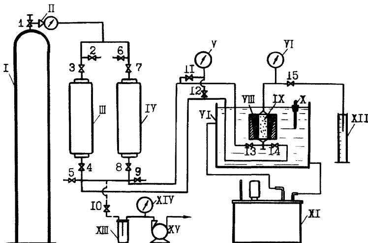
I-баллон с гелием; II-газовый редуктор; III-контейнер для пластовой воды; IV-контейнер для закачиваемой воды; V-VI-образцовые манометры; VII-водяная баня; VIII-кернодержатель; IX-образец породы; X-термометр; XI-термостат; XII-мерный цилиндр; XIII-склянка Тищенко; XIV-вакуумметр; XV-вакуумный насос. I-15-вентили.
