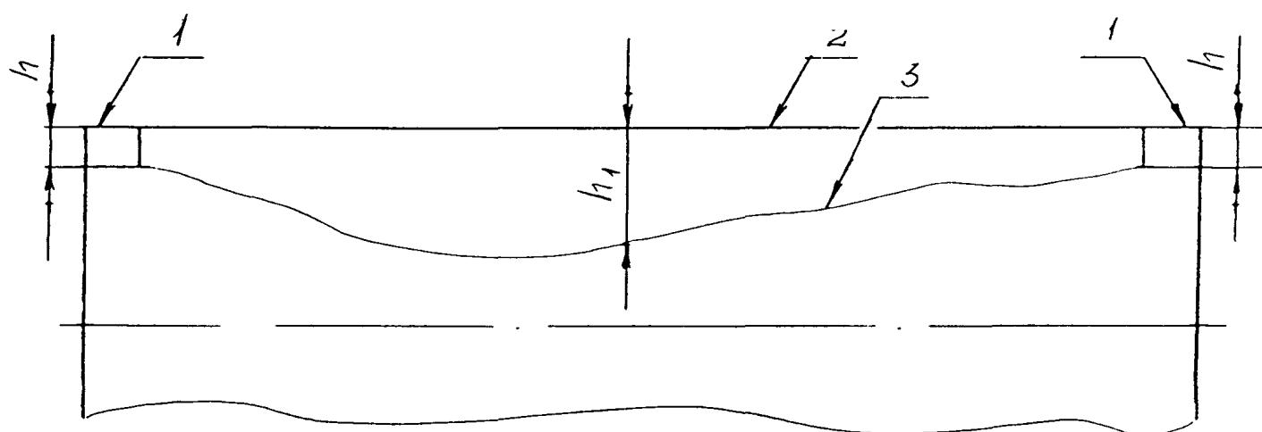
Рисунок Б 1 "Схема определения кривизны труб"
