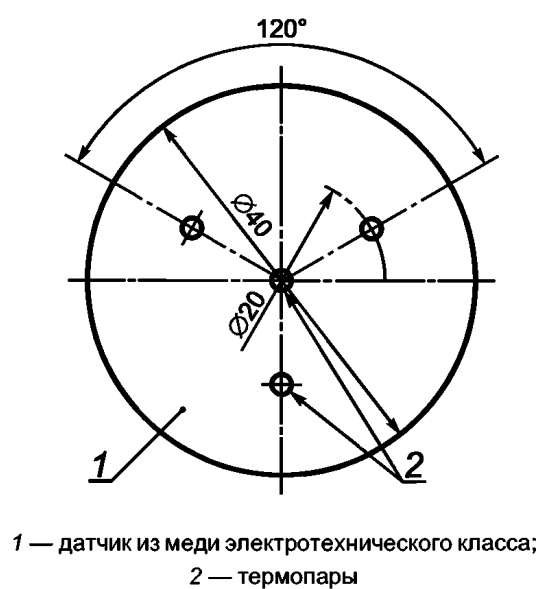
а) Установка термопар в калориметре
