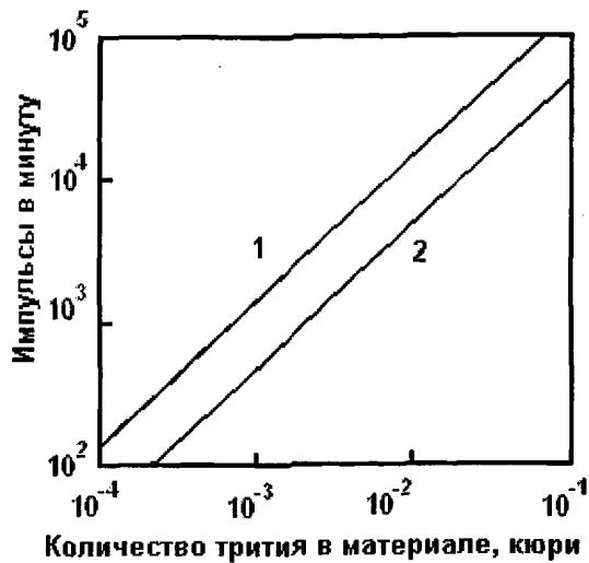
**Рис. Ж.1.** Зависимость скорости счета тормозного излучения от количества трития в наипротивом латексе Л-7 (1) и перфлоне ПК-4 (2)
