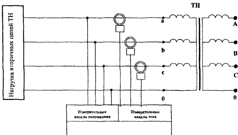
Рисунок 1 – Схема выполнения измерений мощности нагрузки ТН, включенных по трехфазной схеме
