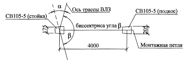
Схема установки стойки и подкоса
