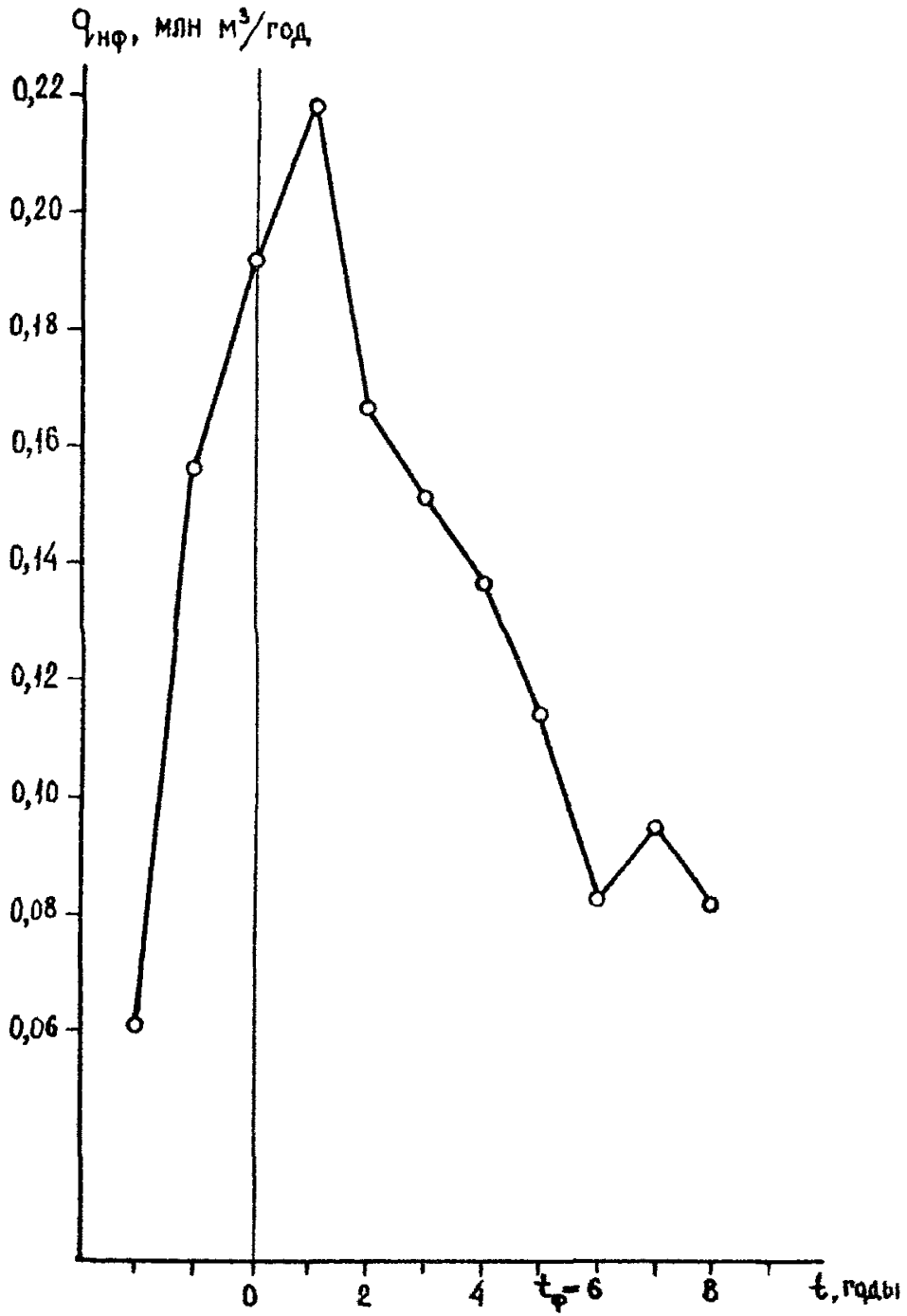
Рис. П.3.2. Гипотетическое изменение годовых отборов негтя из гипотетической залежи во времени.
