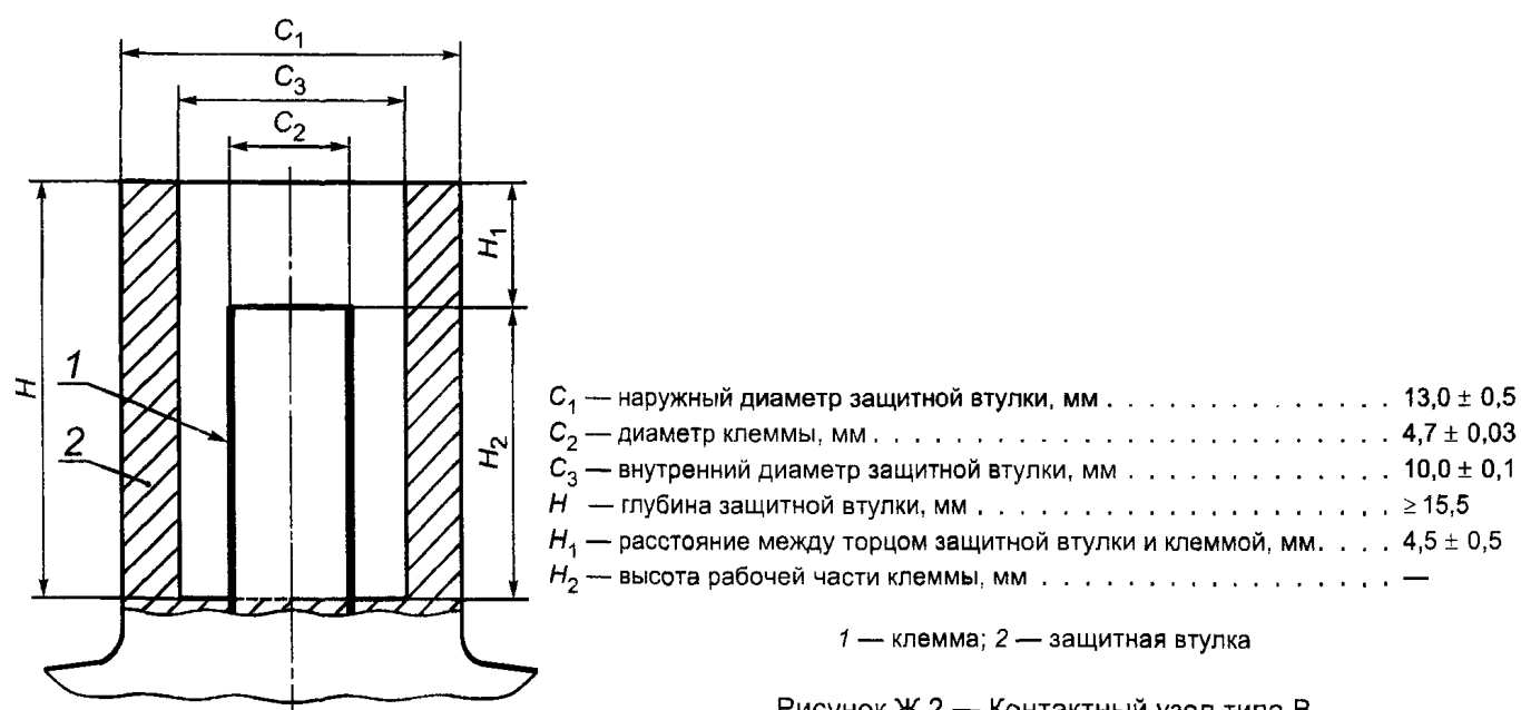
Рисунок Ж.2 — Контактный узел типа В
