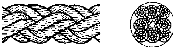
Рисунок 3 — Конфигурация 8-рядного плетеного каната (тип L)
