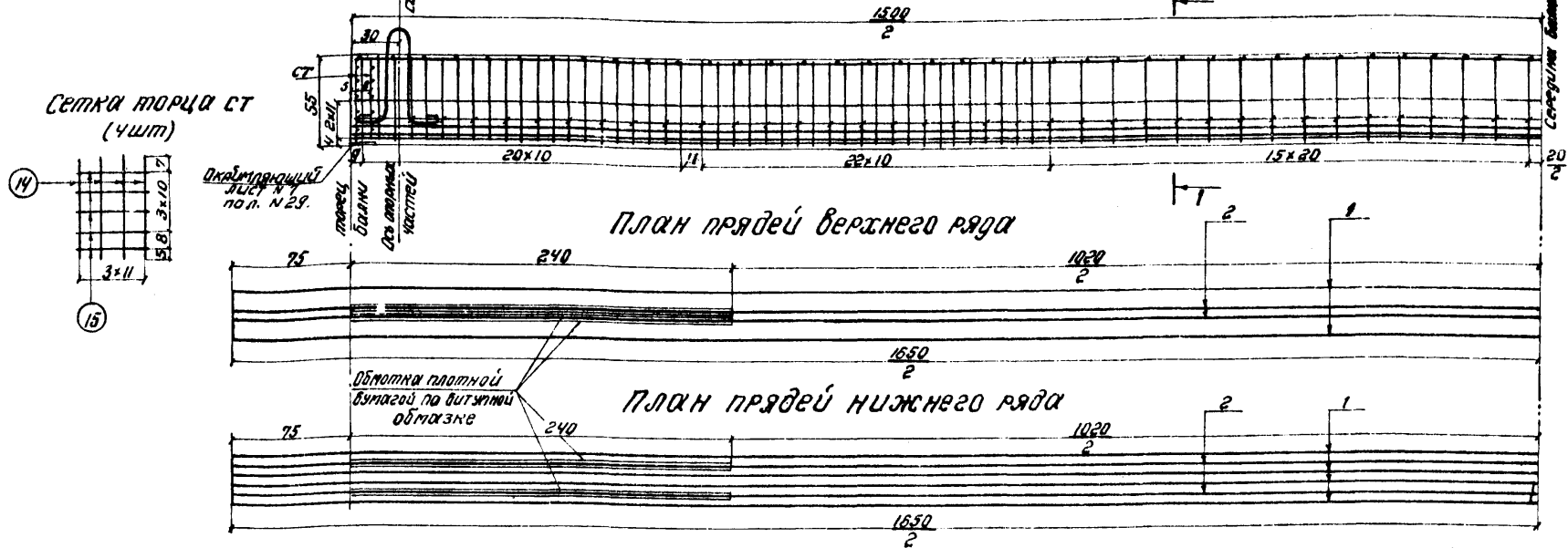
Схемы расположения сеток верхние сетки плиты
