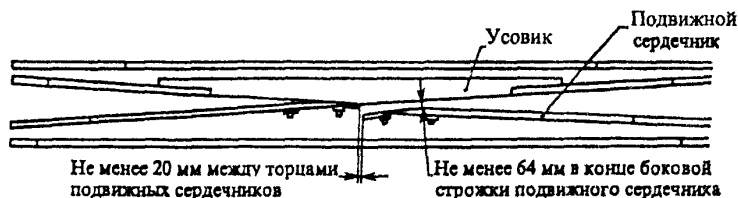
Рис. 3.16. Места контрольных измерений ширины желобов между усовиком и подвижным сердечником в тупых крестовинах с подвижным сердечником
