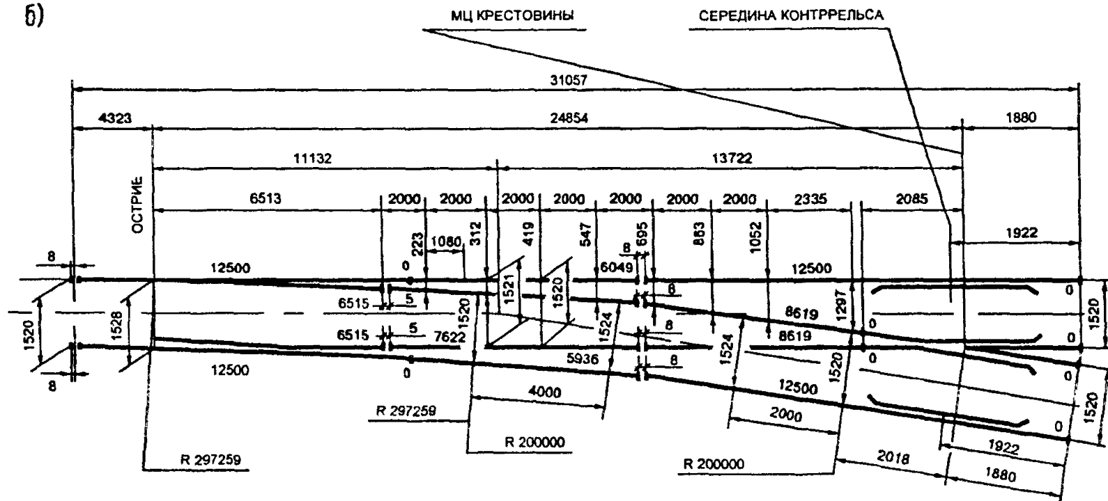
Рис. 5.24. Эпюра укладки (а) и схема разбивки (б) стрелочного перевода типа Р50 марки 1/9. Проект 2643
