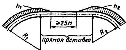
Рис. 2.2. Схема отводов возвышения наружной рельсовой нити при сопряжении смежных кривых одного направления при достаточной длине прямой вставки между ними
