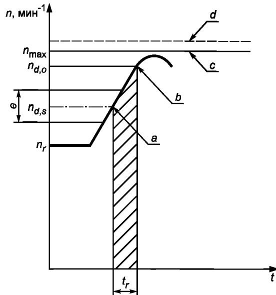
$t$  — время;  $n$  — частота вращения двигателя;  $a$  — частота настройки устройства ограничения частоты вращения;  $b$  — частота срабатывания устройства ограничения частоты вращения;  $c$  — максимальная допустимая частота вращения;  $d$  — предельная частота вращения;  $e$  — диапазон настройки
