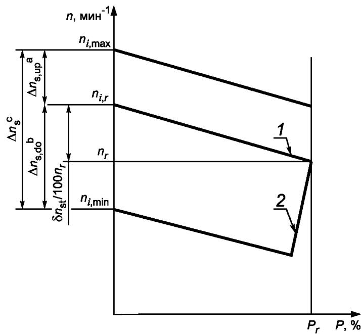
$P$  — мощность двигателя;  $n$  — частота вращения двигателя;  $a$  — верхний диапазон уставки частоты вращения;  $b$  — нижний диапазон уставки частоты вращения;  $c$  — диапазон уставки частоты вращения; 1 — характеристика частота вращения/мощность; 2 — предельное значение мощности
