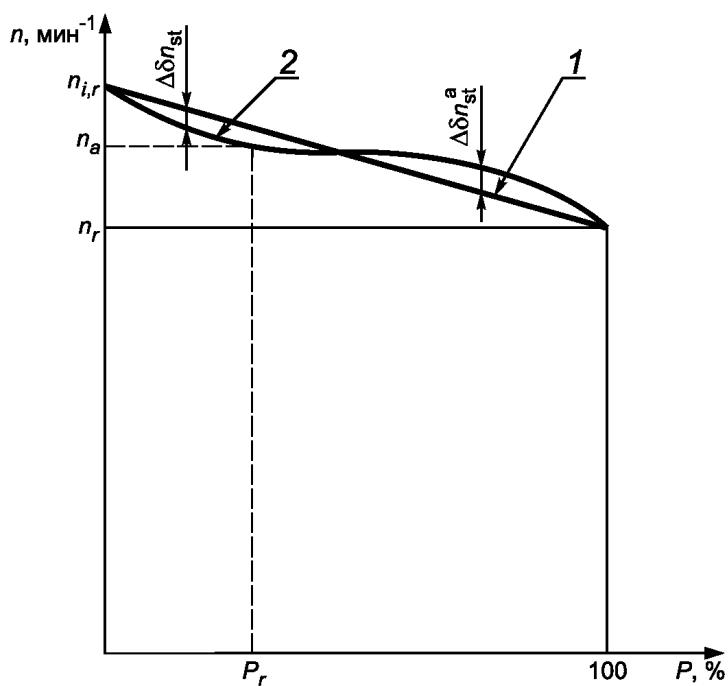
$P$  — мощность двигателя;  $n$  — частота вращения двигателя;  $a$  — отклонение характеристики частота вращения/мощность; 1 — линейная характеристика частота вращения/мощность; 2 — характеристика частота вращения/мощность
