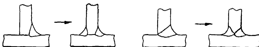
Рисунок 5.4 – Применение симметричных угловых швов
