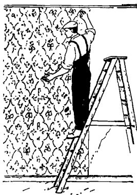
Рисунок 15 – Наклейка полотнищ с подбором рисунка
