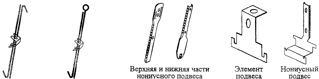
Рисунок 13 – Варианты подвесов системы Trulok
