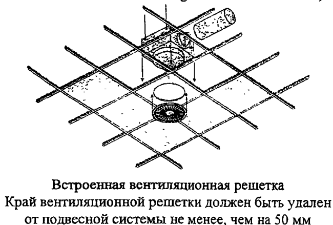
Рисунок 25 – Примеры встраивания технического оборудования
