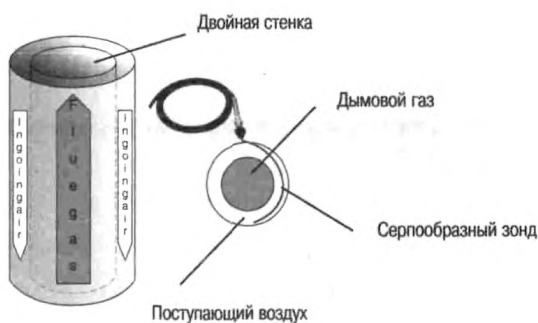
Рис. 20: Замер уровня O_2 в межстенном пространстве дымохода серпообразным зондом
