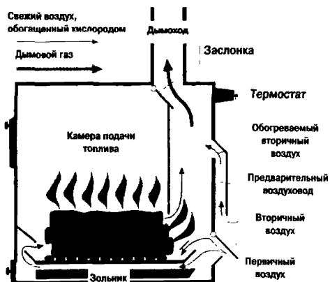
Рис. 6: Простая колосниковая печь
