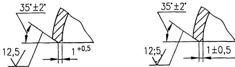
Примечание - Для отводов  $D_h = 57$  мм допускается торцовка без разделки кромок.
