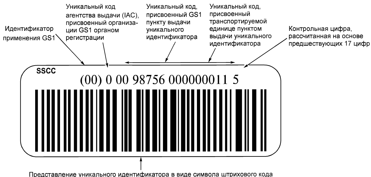
Рисунок В.1 — Представление уникального идентификатора транспортируемых единиц в символе штрихового кода GS1-128
