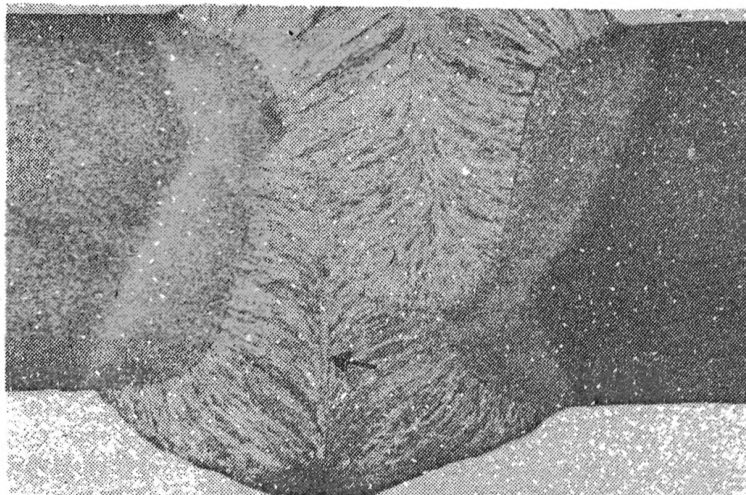
Рис. 49. При автоматической дуговой сварке стали 09Г2С проволокой Св-08МХ под флюсом АН-47, травление в реактиве № 2 (см. табл. 1), 1,5 х
