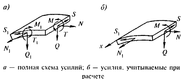
Рисунок 9.4 — Усилия, действующие в длинных цилиндрических оболочках и складках
