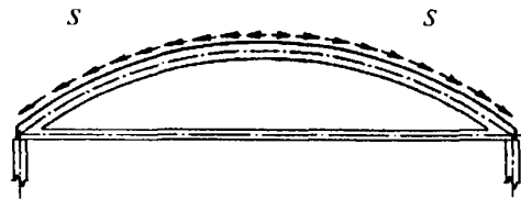
Рисунок 9.9 — Схема передачи усилий с оболочки на диафрагму
