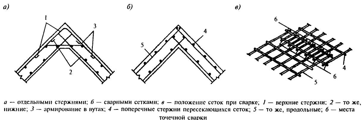
Рисунок 8.5 — Армирование пересекающимися стержнями жесткого сопряжения граней треугольной складки
