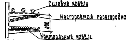
Рис. 6 Силовые кабели и контрольные кабели в пучках
