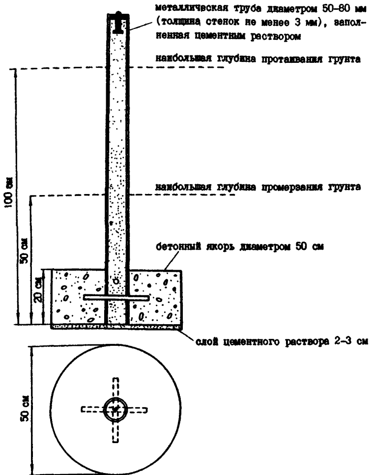
Рис. 6.2. Центр пункта триангуляции, полигонометрии, трилатерации 2, 3, 4 классов для районов глубокого (свыше 1,5 м) промерзания грунта и для районов вечной мерзлоты. Тип 2 г. р.
