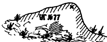
Рис. 6.10. Типы знаков временного закрепления съёмных сетей
