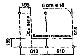
Расположение отверстий для крепления вентилятора
