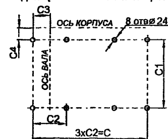
Схема расположения отверстий для крепления вентиляторов
