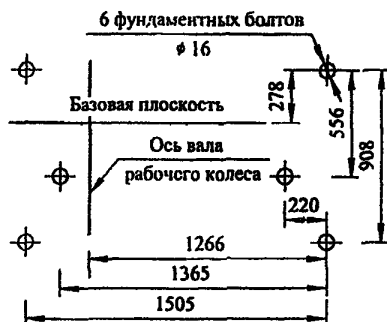
Схема разметки под фундаментные болты вентилятора ВРП-100-45-10.
