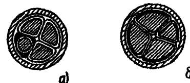
Рис. Схема четырехжильных кабелей а - с секторными рабочими жилами и круглой нулевой жилой, б - с секторными жилами
