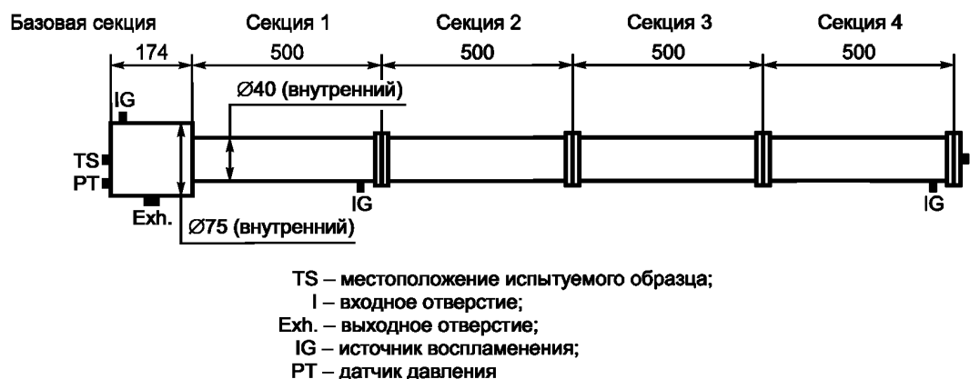
Рисунок 21 — Установка для испытаний дыхательных и дренажных устройств
