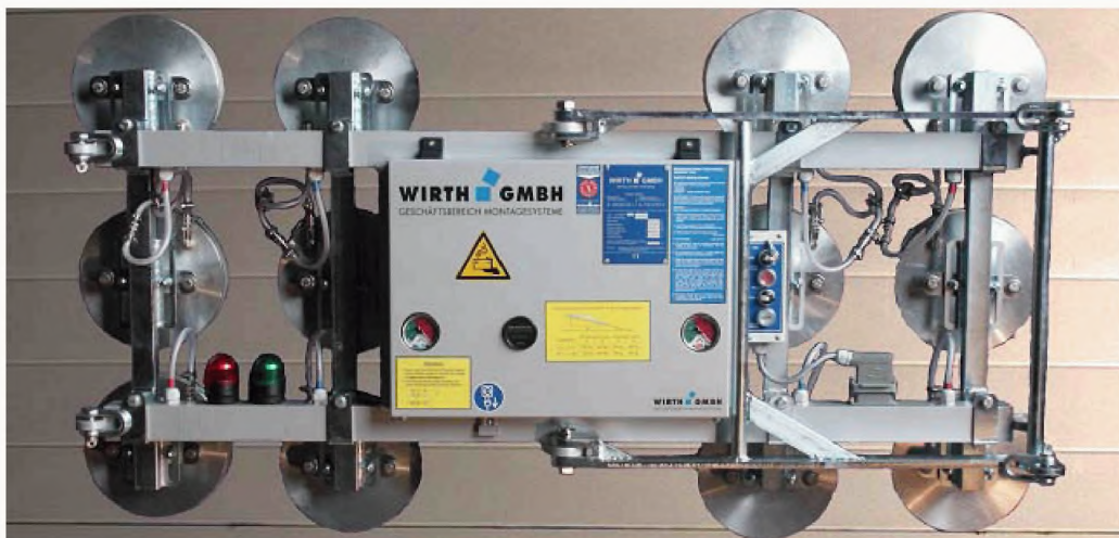
Рисунок 136 – Транспортирование и укладка стеновых и кровельных панелей на месте монтажа с помощью установочной системы Oktopus KT-B.
